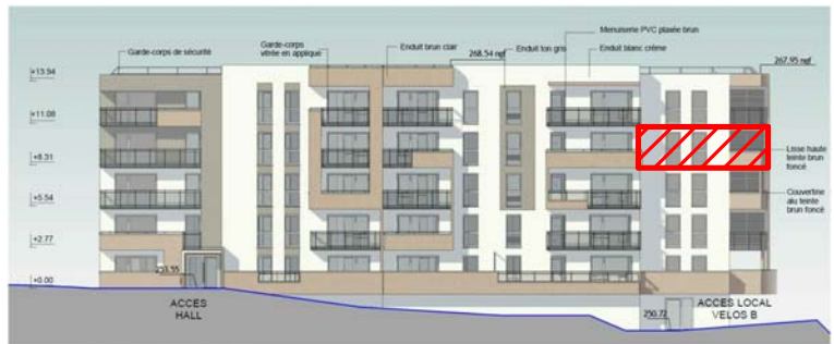
PC5.2 Elévation SUD-EST bât.B Ech: 1 : 250
