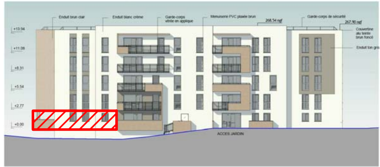
PC5.2 Elévation NORD-OUEST bât.B Ech: 1 : 250
