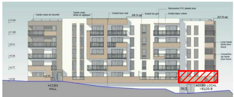
PC5.2 Elévation SUD-EST bât.B Ech: 1 : 250
